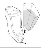
2.6 吐水口の下にコップか大きな容器を置いた後に、注水ボタンを押して注水を開始してください。もう一度注水ボタンを押すと注水が止まります。本製品の各部に水を十分行き渡らせるためにリザーバーが空になるまで注水を続けてください。注水ボタンの機能については2.9 2.10 を参照してください。
