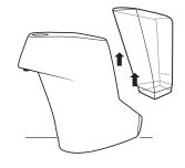
5.2 上蓋を固定している2ヵ所のネジを回して取り外してください。この 5.2 のステップの作業は付属のネジ回しを使用して行ってください。
