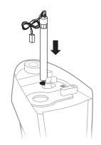
4.7 UVランプコネクターは正しい向きに接続していなければ装着できません。UVランプコネクターの端子が正しく並んでいることを確認してから再接続してください。
