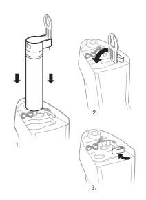
5.22 上蓋の前側を最初に装着して、上蓋を再取付けしてください。上蓋が正しく装着されていないと、本製品の電源は入りません。
