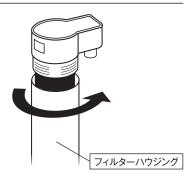
**5.6** 図に示すようにフィルターカートリッジをフィルターの先端部分から引き抜いて、フィルターカートリッジを取り外してください。
