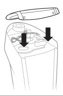
**5.23** 上蓋を固定するために付属のネジ回しを使って2ヵ所のネジを締めてください。
