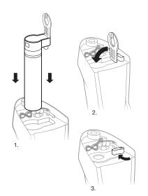
5.10 上蓋の前側を最初に装着して、上蓋を再取付けしてください。上蓋が正しく装着されていないと、本製品の電源は入りません。
