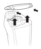
4.4 UVランプコネクターを手に持ち、UVランプコネクターのクリップ部分を押してから引き上げて、UVランプコネクターを外してください。
