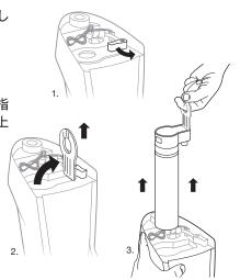
5.18 図に示すようにフィルターの本体部分を反時計回りに回して、フィルターの先端部分からフィルター本体をねじって外してください。フィルターハウジングに残っている水を空にしてください。この水は排水管に流しても問題ありません。空にしたフィルターハウジングを普通の水道水を使って水洗いしてください。
