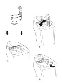
4.10 上蓋の前側を最初に本体の溝に差し込ん で装着して、上蓋を再取付けしてください。 上蓋が正しく装着されていないと、本製品 の電源は入りません。
