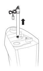
4.6 UVランプの末端の白色キャップ部分を持って、新しいUVランプを挿入してください。UVランプは、図に示すように挿入し、一番奥まで確実に押し込んでください。
