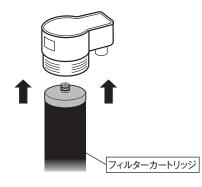
**5.20** フィルターの先端部分をフィルターハウジング部分に時計回りに回してねじ込み、しっかり取り付けられていることを確認してください。
