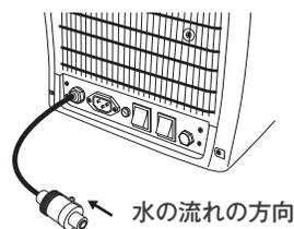
4. 逆止弁の反対側に、残りの導水チューブを差し込みます。
